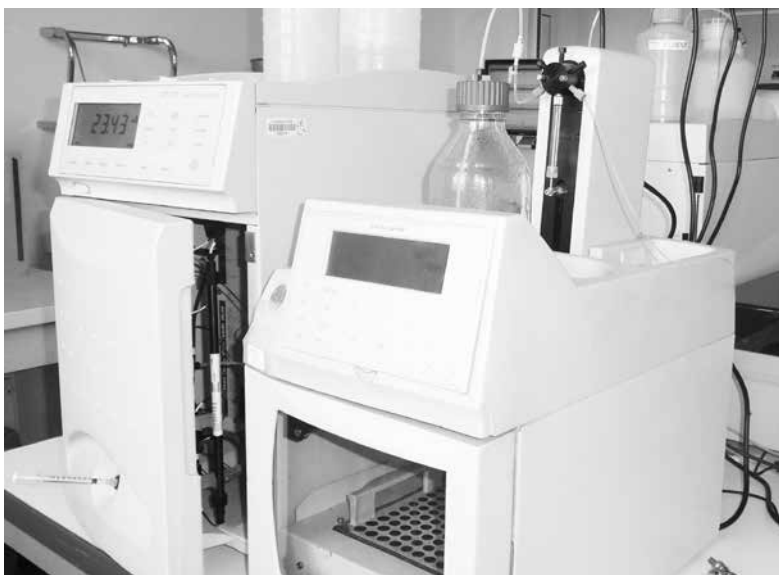
Système de chromatographie ionique utilisé pour analyser les échantillons d'halogènes
